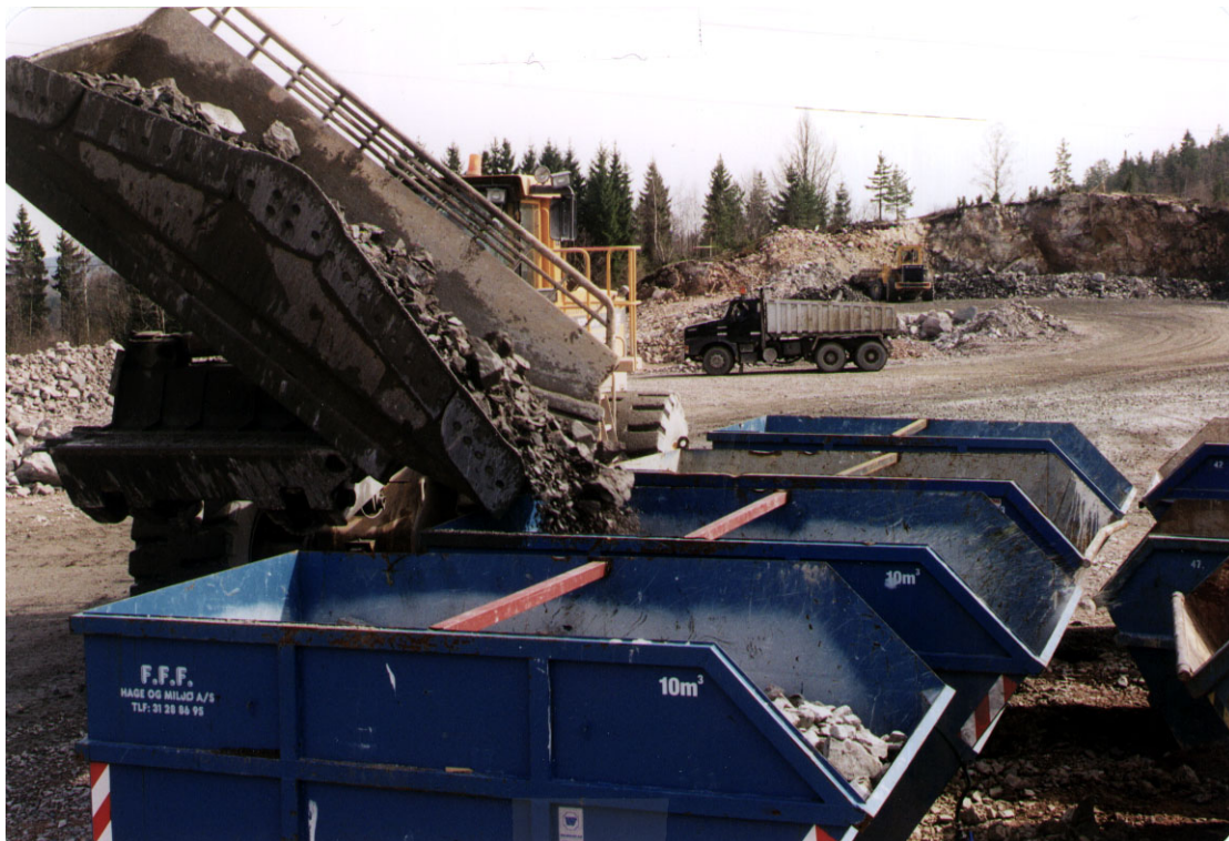
Figur 4. 1 1/2 skuffe tunnelmasse dumpes i hver testkontainer.
