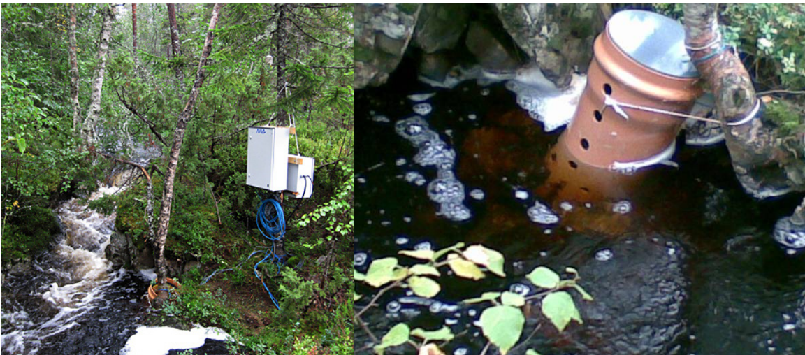
Figur 2. Målestasjon ved bekkens utløp. All elektronikk er montert i vanntette skap som har strømforstyrning fra solcelle.
