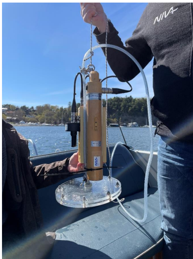
Figur 17. Pumpesystemet som ble brukt ved prøvetaking på stasjon Br2 den 6. mai 2023. Det er Evgeniy Yakushev som holder måleren. Han har også designet prøvetakningssystemet. Foto André Staalstrøm.
