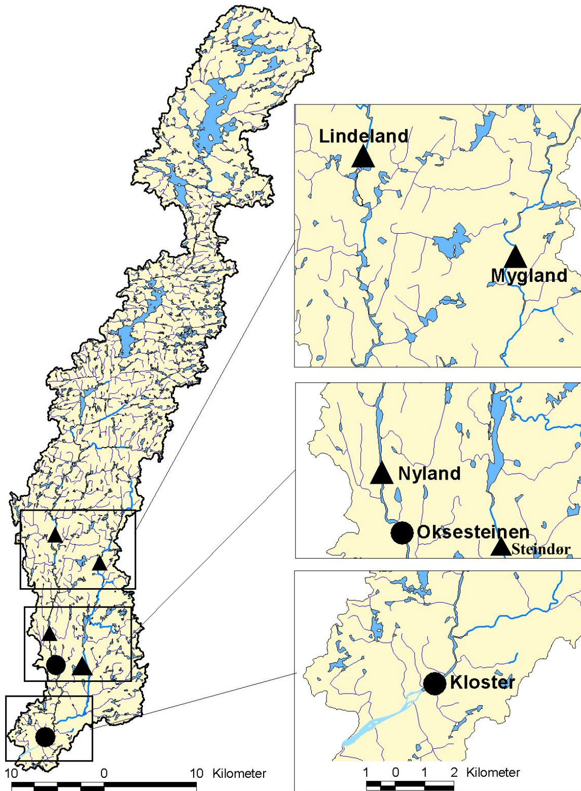
Figur 1. Kart over nedbørfeltet til Kvina med utsnitt av tre områder i stor målestokk som viser plasseringen av kalkdoserere (triangler) og pH-målestasjoner (sirkler).
