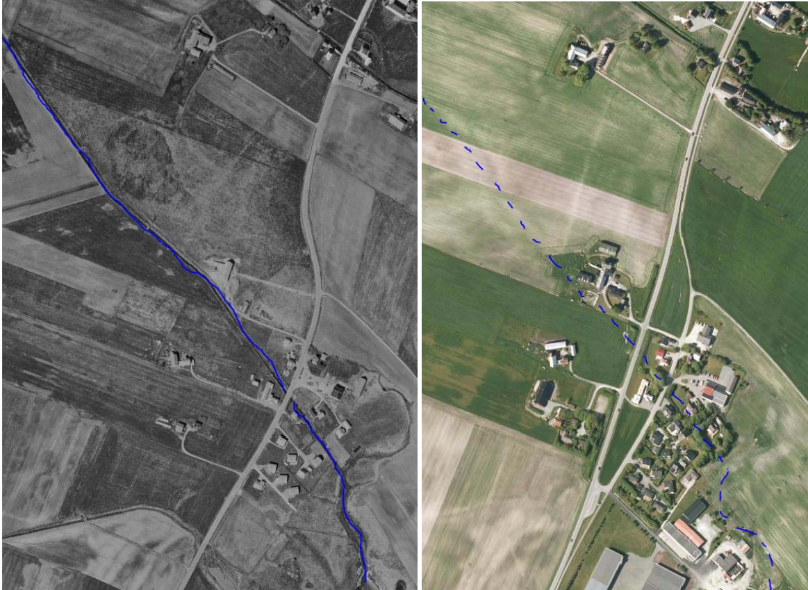
Figur 36. Vikagrøfta anno 1969 (åpen kanal) og 2012 (lukket i bakken). ( Flyfoto: http://kart.finn.no/ )
