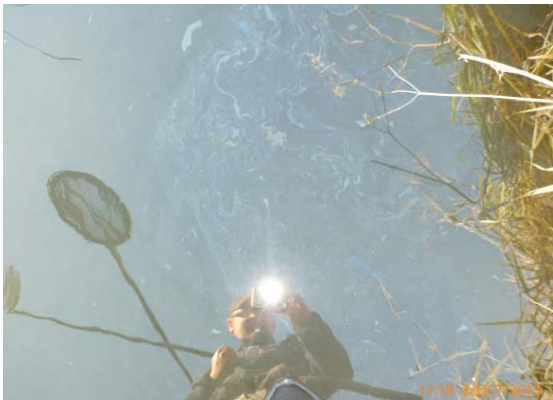
Figur 23. Synlig oljefilm på vannoverflaten i Djupdalsbekken. Spesielt synlig ved oppvirvling av bunnslam, noe som kan indikere at det er avleiringer av oljeholdig stoff i bunnsubstratet fra tidligere utslipp. (Foto: Morten Andre Bergan)
