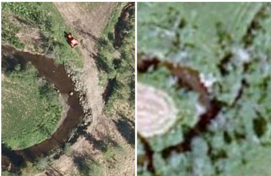
Figur 103. Nyanlagt (2009) traktorvei sperrer utløpsbekken fra Tjønnåstjønna til Sneiselva/Vennelva. Flyfoto fra 2010 (t.v.) og 2009 (t.h.). (Flyfoto hentet fra http://kart.finn.no/ )
