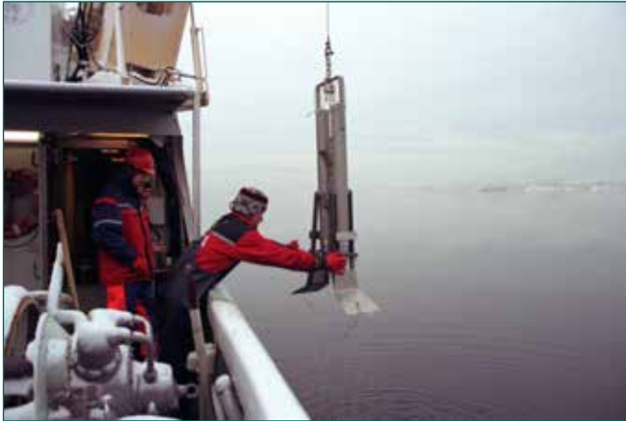
Figur 3. Gemini kjerneprøvetaker. Prøvetakeren tar to parallelle kjerner (foto A. Helland).
