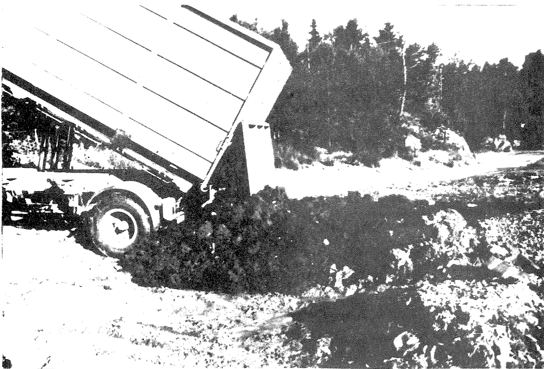
Figur 4. Tømming av avvannet slam gjøres enkelt ved å åpne bakluken og så tippe containeren. Slamkaka er her tilstrekkelig tørr til at den blir liggende i en avgrenset haug.
