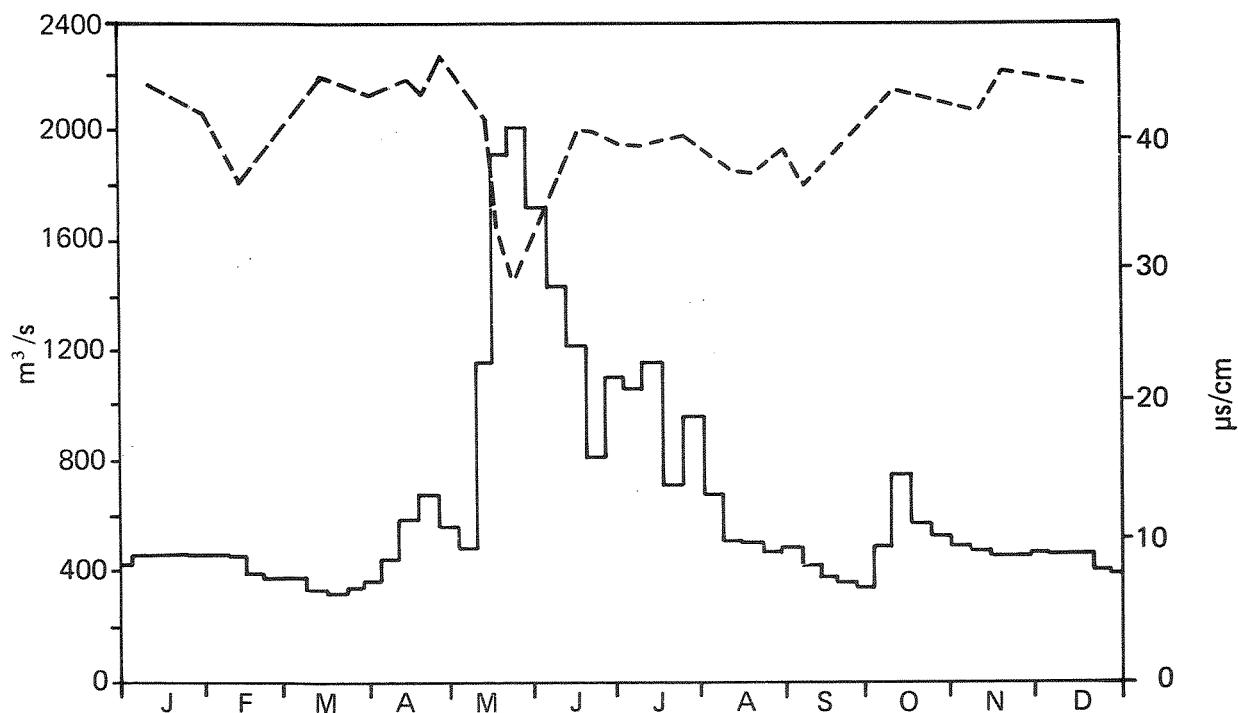
Figur 4. Sarpsfossen, Glåma. Vannføringen i 1981 (Solbergfoss) og variasjon i konduktivitet ( $\mu\text{S}/\text{cm}$  20 °)
