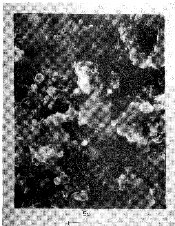
c Sfæriske jernpartikler med størrelse < 1 \mu\text{m}
