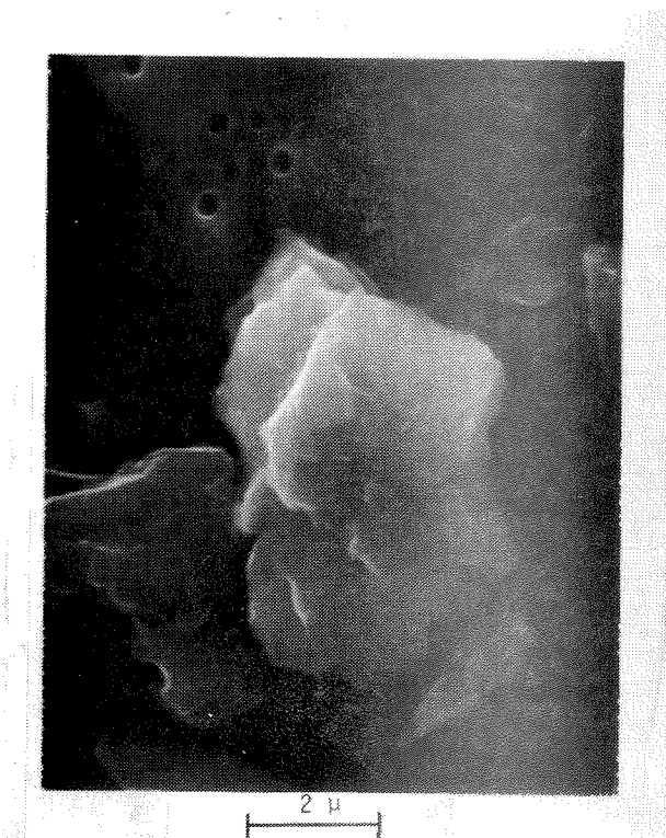
d. Chalcoprytt-partikkel (kobber, svovel og jern). RA9 - 40 m
