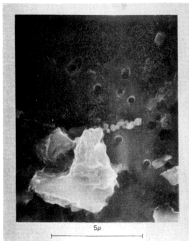
d Sfæriske jernpartikler med størrelse ca. 0,5 \mu\text{m}
