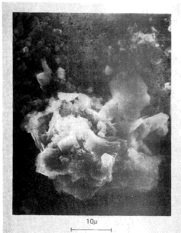
b Partikkelaggregat som inneholder kalsium og jern (kalsiumkarbonat og hematitt ?)
