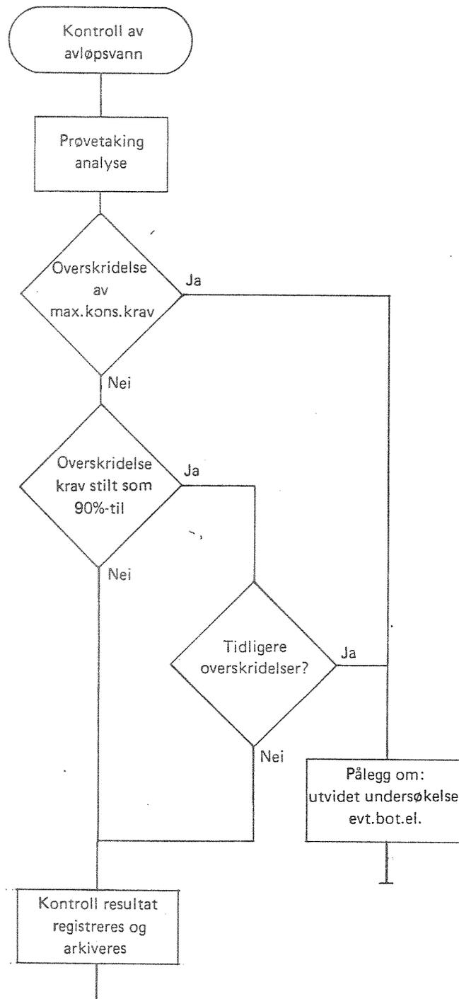
Skjematisk flyt-skjema for gangen i et kontrollopplegg. Diagrammet kan danne utgangspunkt for arbeidet med et EDB-basert system
