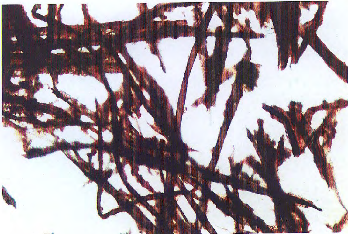
Fig. 9 Tyrifjorden (st. 33) 0-5 cm sjiktet med glødetap 26%. Bilde viser mye fiber både ferske og mer nedbrutte. 50 x forstørrelse.
