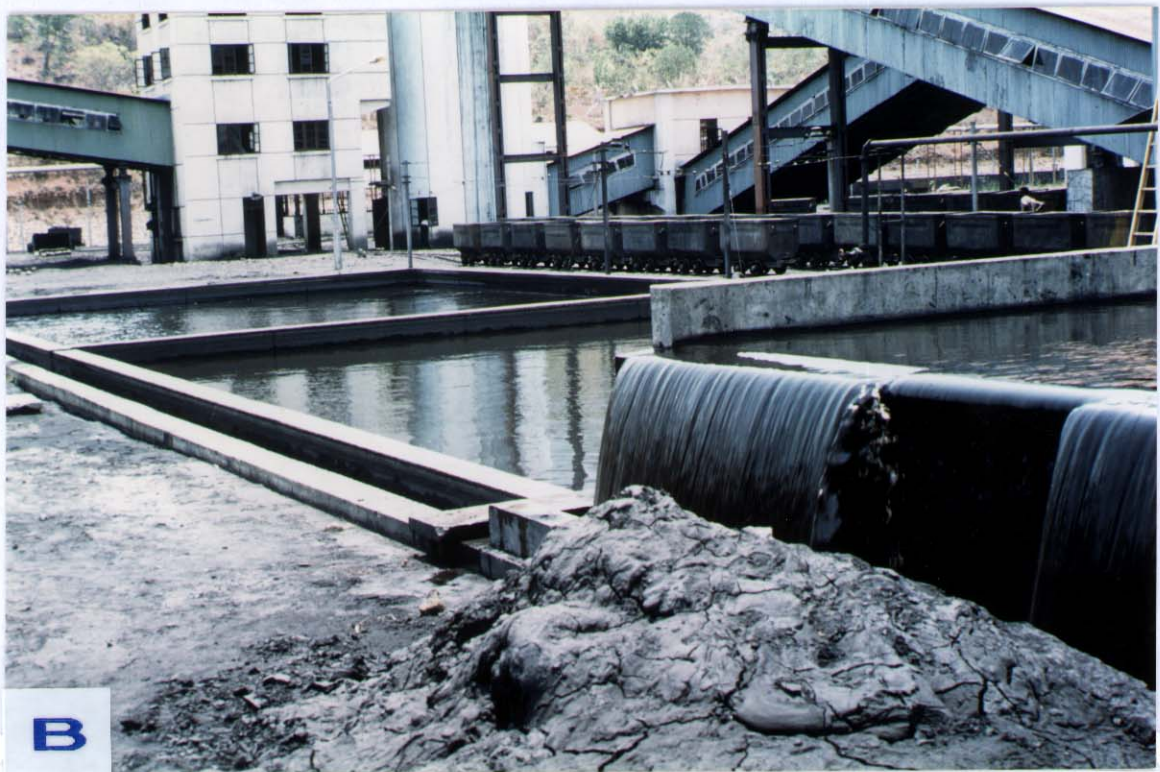
Figur 6. Kiwira Coal Mine. A. Avfall fra vaskerianlegg. B. Sedimentasjonsbasseng for vaskerivann. C. Okeravsetninger inne i gruen.
