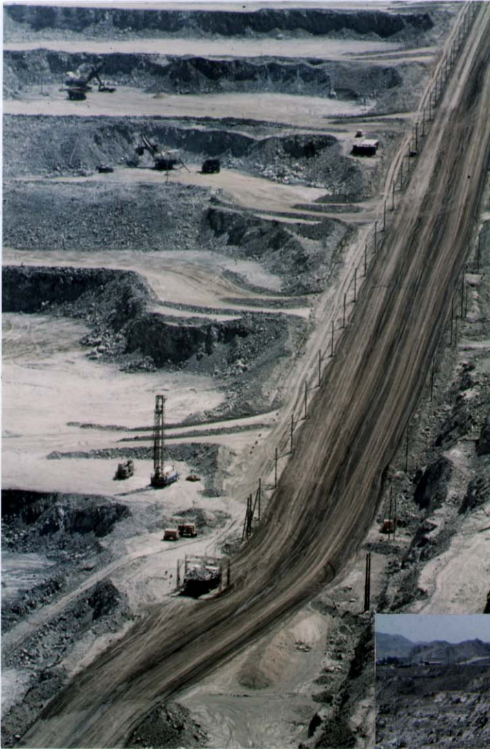
Figur 29. Fortsettelse Rössing Uranium Mine. B. Ulike aktiviteter: Boring og opplasting. Bilen nede på bildet er inne til kontroll for måling av urangehalt. Sjøføren får beskjed om lasten skal til prosessanlegg eller til gråbergstipp.
