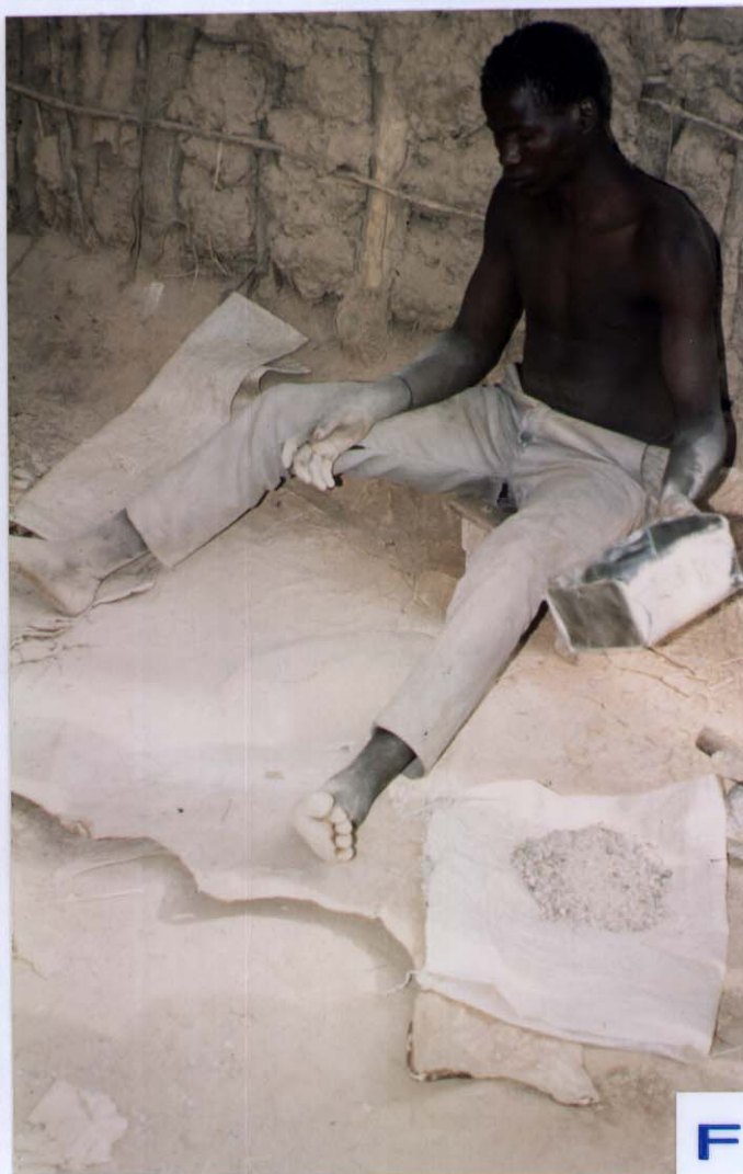
Figur 15. Fortsettelse. Resten (D.) knuses (E.), siktes (F.) og knuses igjen ned til et fint støv av gullholdig kvarts, og amalgameringsprosessen kan begynne.
