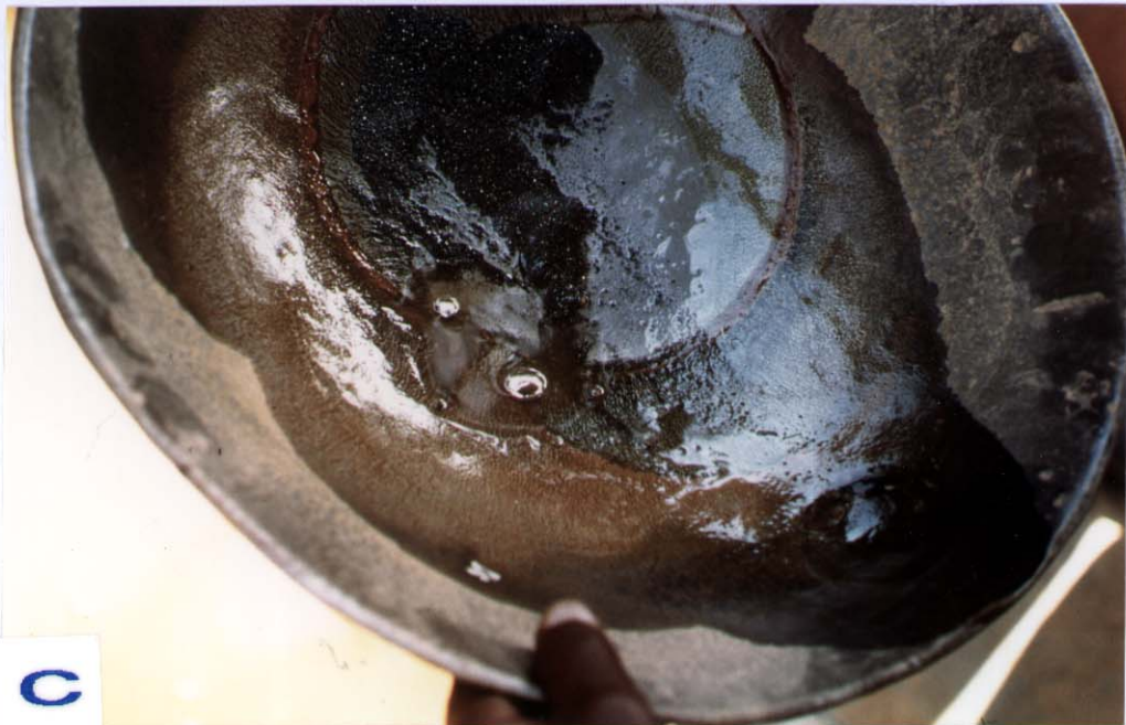
Figur 16. Lupa Gold Field. A. og B. Ved hjelp av vann vaskes lettere mineralpartikler vekk. C. Metallisk kvikksølv settes til. Noe av dette reagerer med gullstøvet og danner amalgam. E. Amalgam og kvikksølv samles i et klede. F, Overflødig kvikksølv presses ut.
