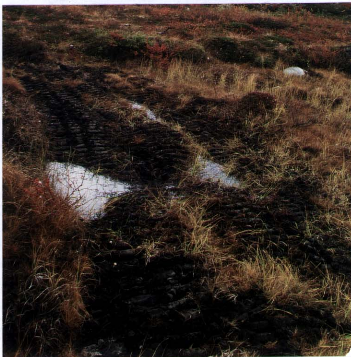
Figur 13. Bildet viser et sted hvor beltevogna har kjørt tre ganger i samme trase i sving.
