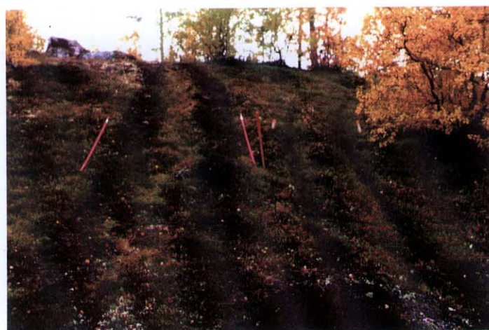
Figur 11. Bildet til venstre viser en bakke på Porsangmoen dominert av blåbær og krekling–vegetasjon. I beltevogntraseen til venstre er det kjørt 8 ganger, mens det er kjørt 24 ganger i sekshjulings trasee til høyre på bildet. Bildet til høyre viser ei furu som er skadet på grunn av nærkontakt med beltevogna.
