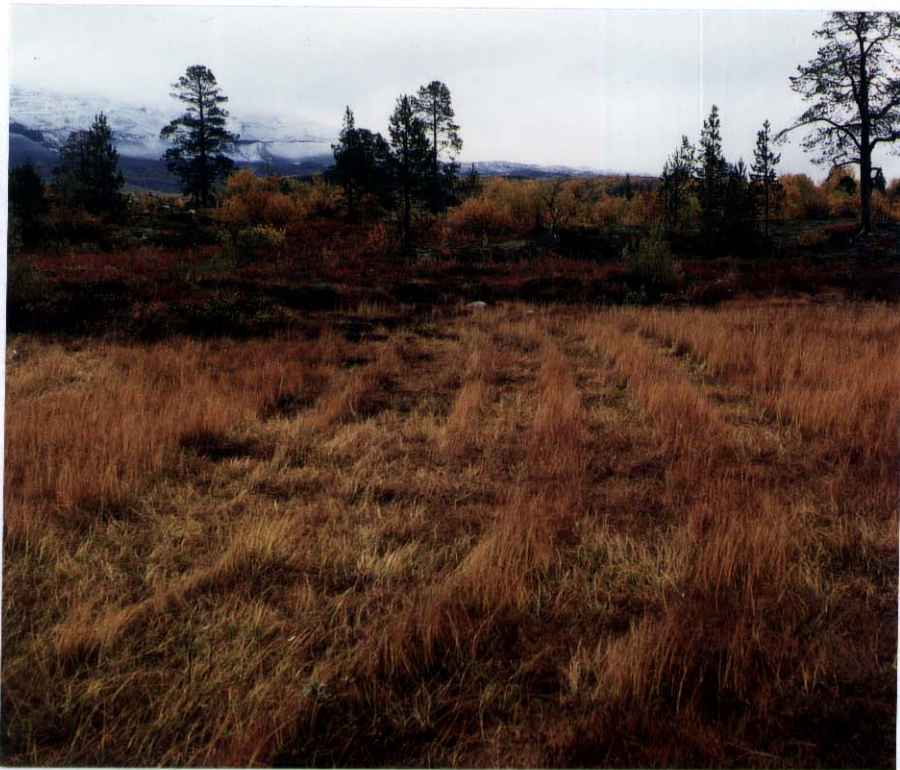
Figur 12. Bildet til venstre viser en fastmattemyr som er overkjørt tre ganger av beltevogn, men ikke i samme spor.
