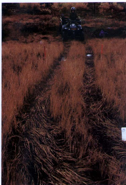
Figur 9. Bildet viser resultatet av tre kjøring med beltevogn (til venstre) og sekshjuling (til høyre) på fastmattemyr på Porsangmoen.
