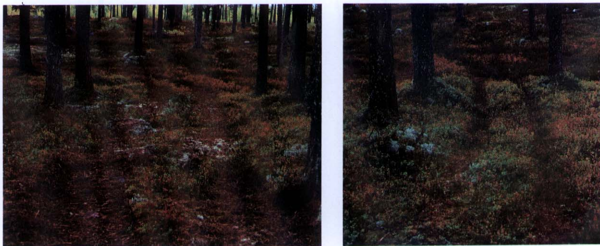
Figur 10. Bildene er fra bærlyngskog på Terningmoen og viser hvordan det ser ut etter 16 overkjøringer med beltevogn (venstre) og sekshjuling (høyre). Bildene er tatt omlag to måneder etter overkjøringene fant sted.
