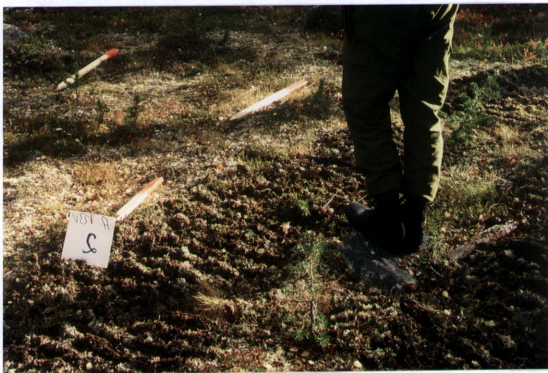
Figur 8. Bildet er fra lavdominert mark på Porsangmoen. Kjøretraseen til beltevogna er nærmest, mens sekshjulingens trase er oppe til venstre mellom pinnene. Bildet viser med all tydelighet hvordan beltevognas belter har stor skadevirkning på lavvegetasjonen.
