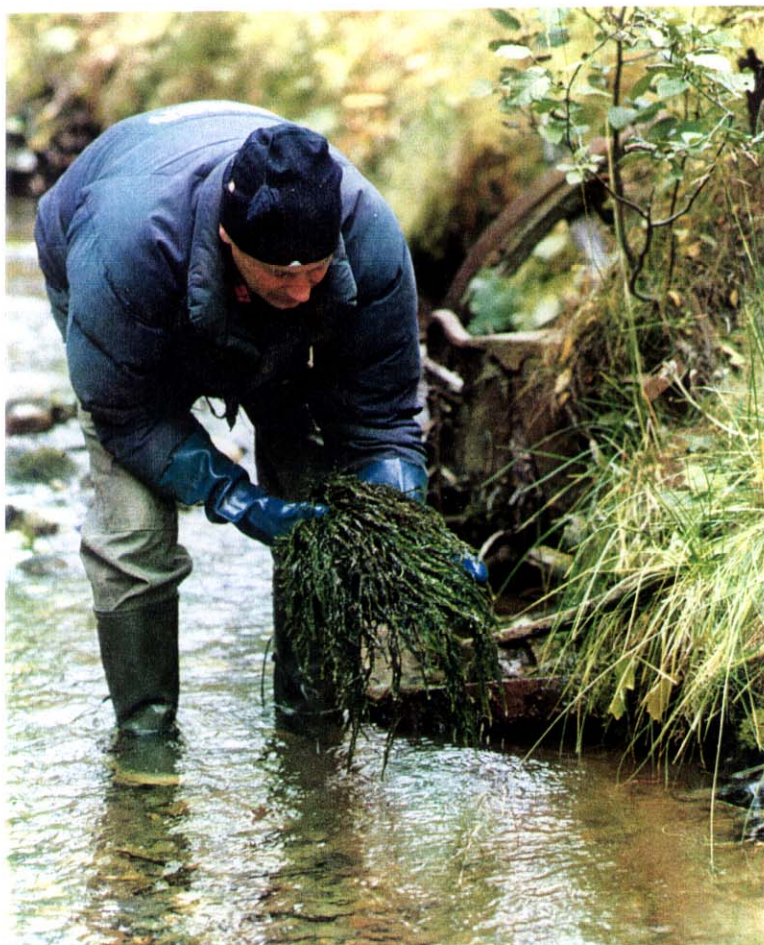
Vannmose blir brukt til akkumuleringsforsøk for tungmetaller
