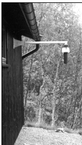
Figur 2. Luftinntak for PM 10 prøvetaking ved Møsvatn
