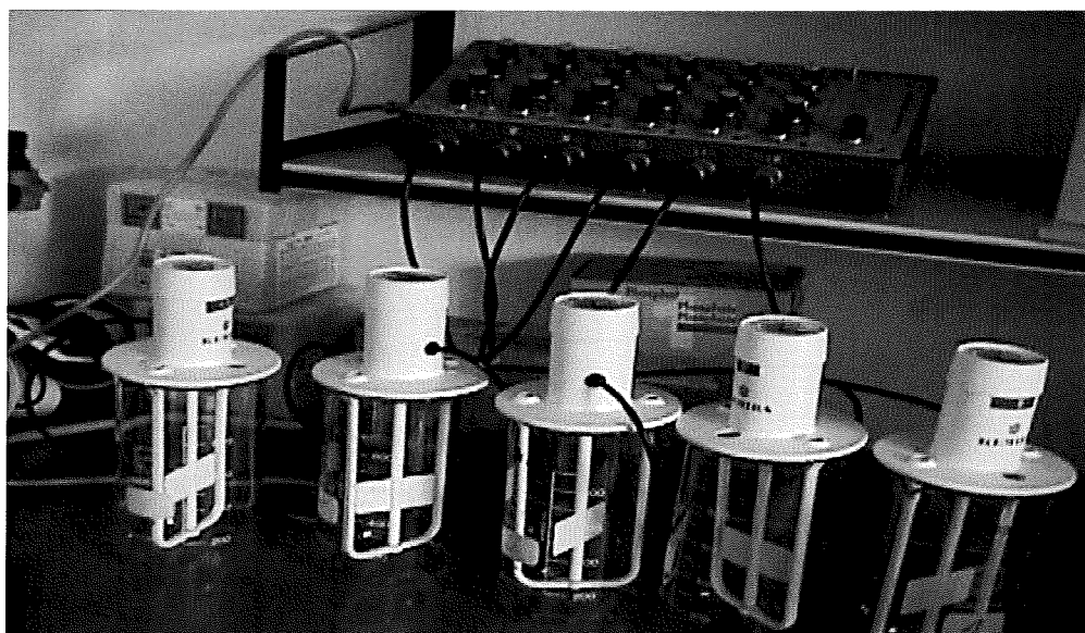
Figur 2. Jar-test apparat med omrørere og begerglass
