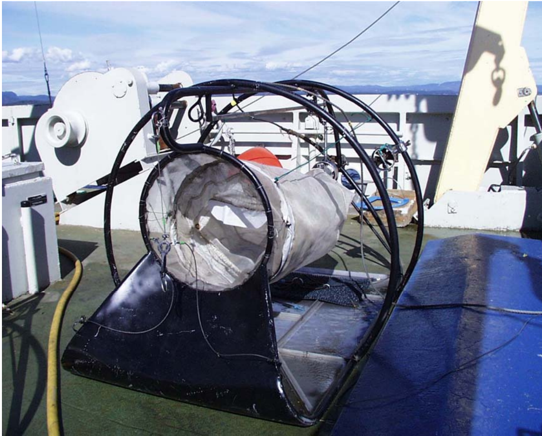
Figur 60. Bunnsløde brukt til å fange dyr på og nær bunnen (foto J.A.Berge)
