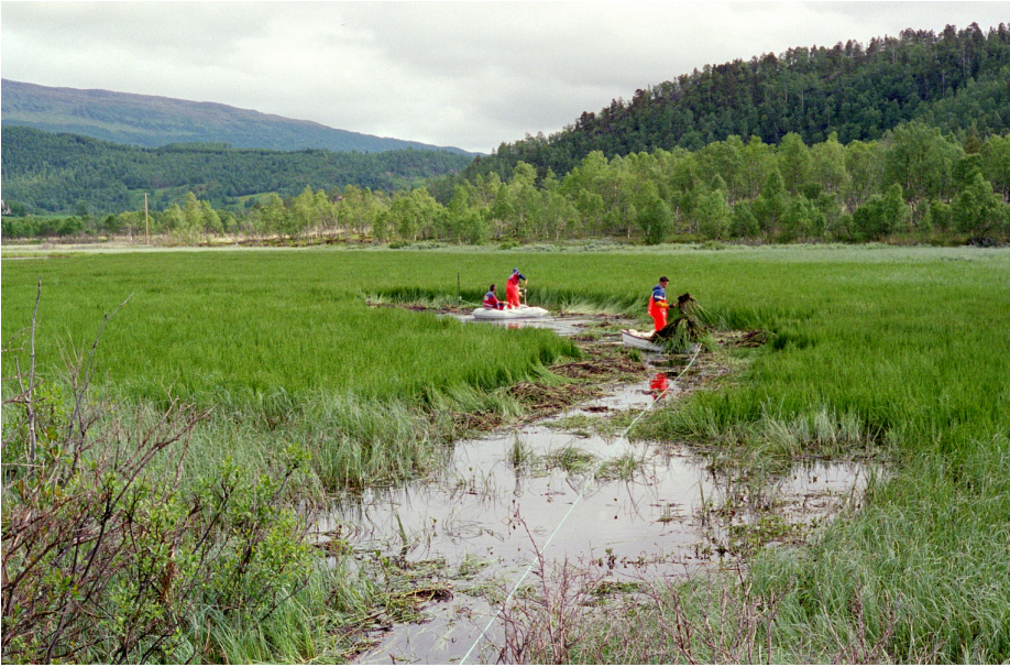
Figur 20. Et prøvefelt i elvesnellebeltet nedstrøms Djupvika ble ryddet sommeren 2001. Det ble her lagt ut 3 typer av geomembran med overdekning av pukk.
