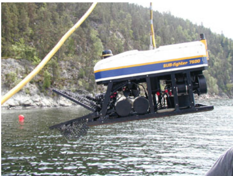
Figur 1. Miniubåt påmontert spesialnett for opptak av tønner (Foto:Thor Olav Sperre).
