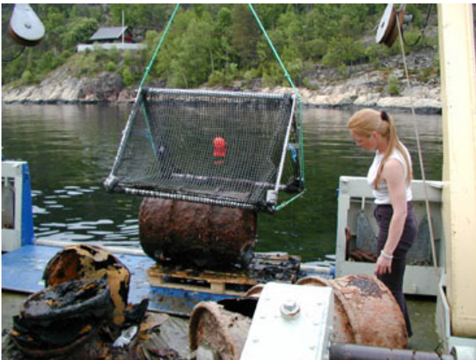
Figur 6. Tre tønner tatt opp fra bunnen ved Steilene. Tønnen nederst til venstre i bilde var meget sterk korrodert og nærmest tom. Også de to andre tønnene er korrodert men har i hovedsak beholdt formen under transport til overflaten. Tønnen nederst til høyre med stålband (Foto:Thor Olav Sperre).
