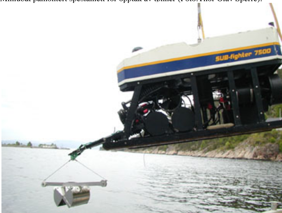
Figur 2. Miniubåt påmontert en grabb for innsamling av sediment for miljøgiftanalyser (Foto:Thor Olav Sperre).
