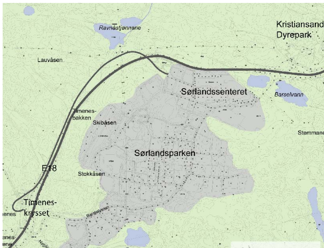
Figur 1. Oversiktskart over som viser eksisterende og planlagt veistrekning (inkl. ny parallellvei) mellom Dyreparken og Timenes. Berørte vassdrag vil være 1) Barselvannene, 2) innløp Ravnåstjønn (drenerer mot Vesvann) og 3) Timenesbekken, som går mellom dagens E18 og planlagt parallellvei nedover Timenesbakken og renner under veien i Timeneskrysset.
