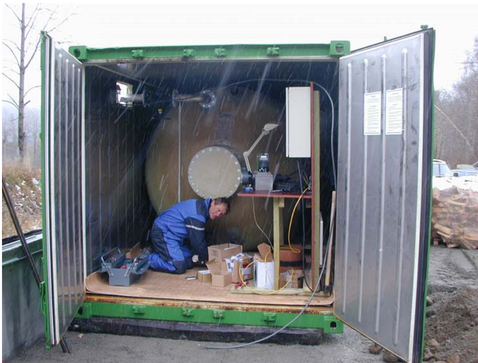
Figur 29. Foto av anlegget i Logåna som viser den ytre kjølecontaineren, styringsenheten og den indre silikattanken.
