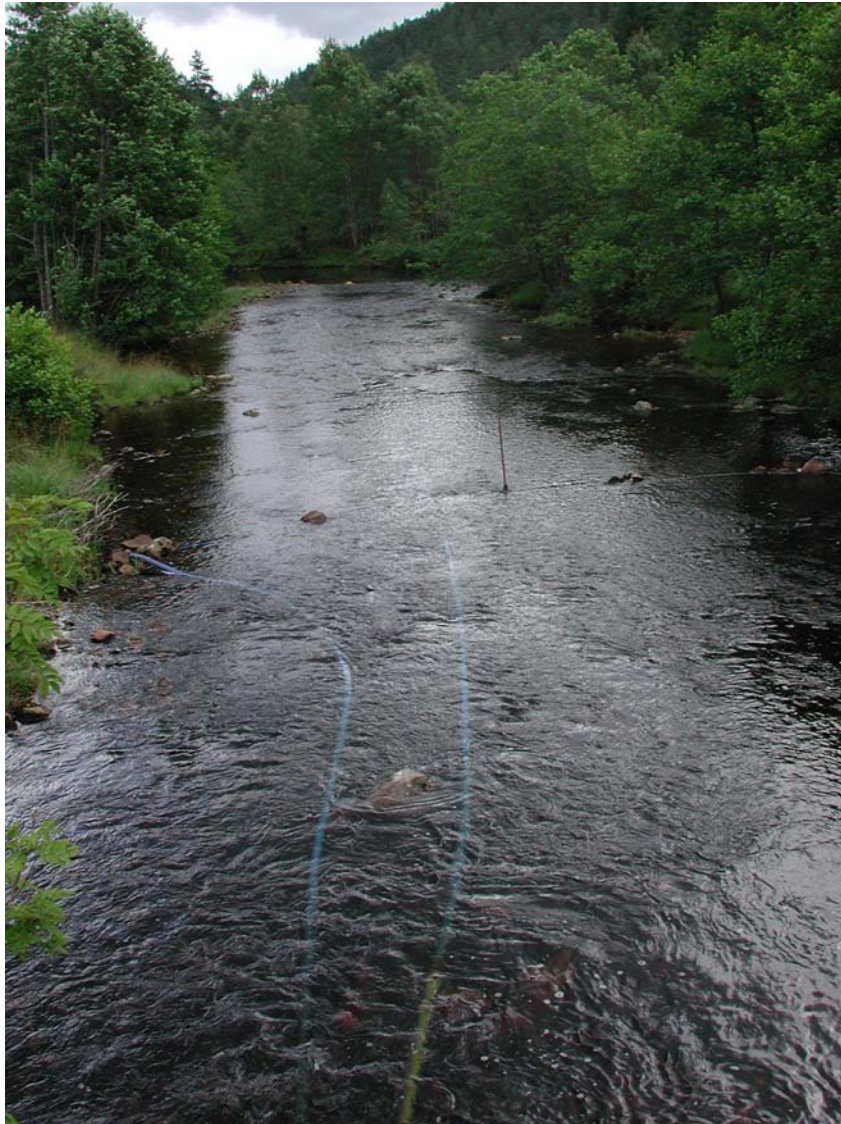
Figur 3. Bilde som viser utlegging av slange for silikatdoseringen i Tangedalselva. Bildet er tatt nedenfra, og oppover mot Tangedalsvatnet. Flytende, fortennet silikatlut ble dosert ut i slangen som ligger nærmest elvebredden. Den var perforert, og lå tvers over hele elva. Den andre slangen ble brukt til å pumpe opp behandlet vann fra ca 50 m nedstrøms for pH-kontroll.
