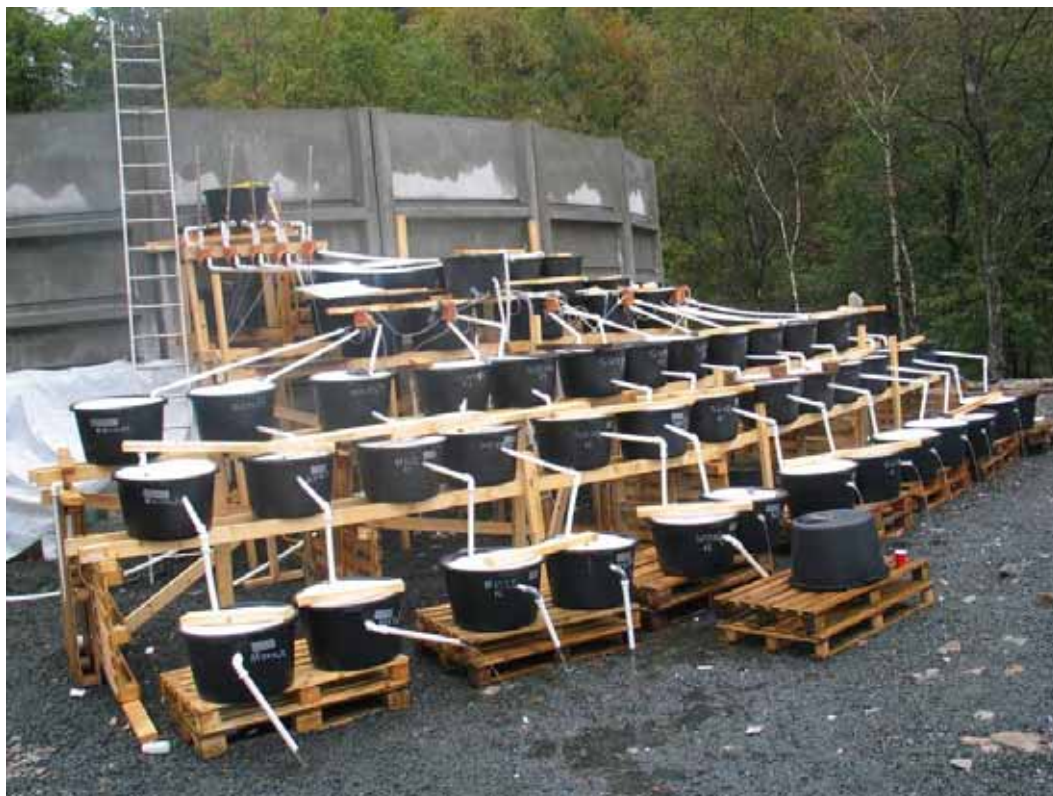
Figur 5. Foto som viser forsøksoppsettet. De tre øverste nivåene består av ferskvann med ulik oppholdstid etter vannbehandling, mens de tre nederste nivåene består av tre ulike oppholdstider etter sjøvannstilsetning (Foto: F. Kroglund).
