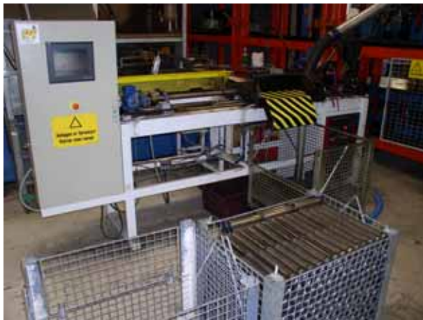
Kappemaskin. Kapping av aluminiumsrør
