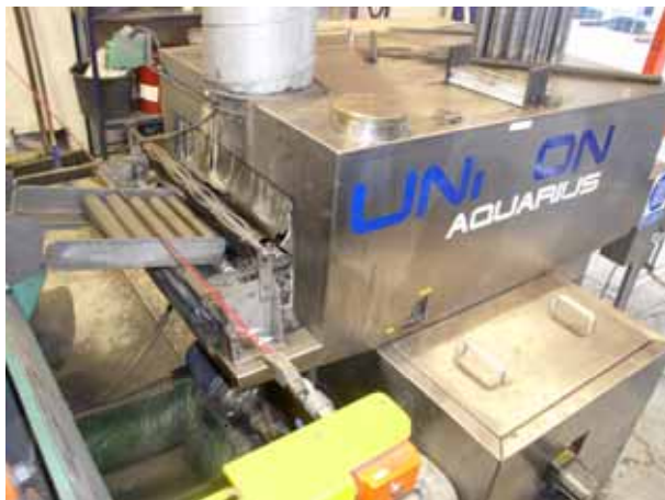
Maskin 1. Avfettingsbad (venstre) med fettfang (nede til venstre i høyre bilde).
