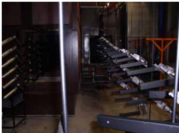
Lakking. Stoldeler på vei inn i lakkeringsmaskin (venstre) og påføring av Corro-coat PE (høyre).
