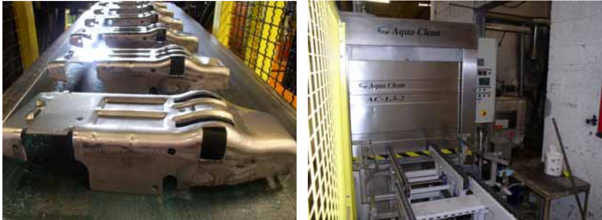
Maskin 4. Ferdige utstansede aluminiumdeler med hinne av Stanseolje nr 1 og GlideWay 220 (venstre) og avfettingsmaskin 4 (høyre).
