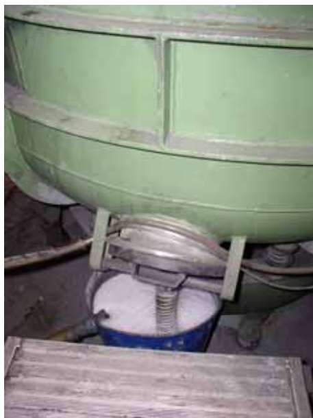
Maskin 2. Maskin for tromling og avfetting av ståldeler (topp venstre), tromling med slipesteiner (topp høyre) og maskinens avløp.
