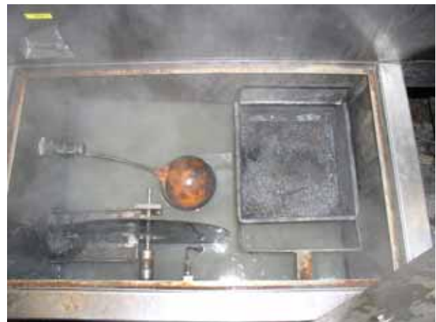
Maskin 1. Avfettingsbad (venstre) med fettfang (nede til venstre i høyre bilde).
