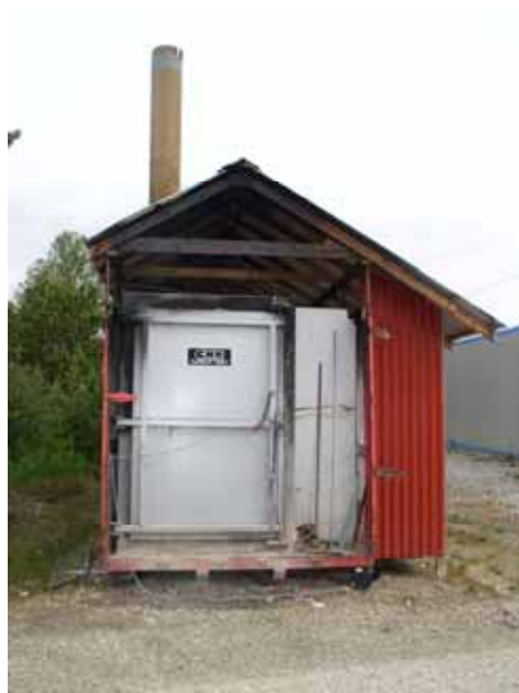
Pyrolyse. Pyrolyseovnen brukt til avbrenning av stoloppheng og koking av epoxypulver.
