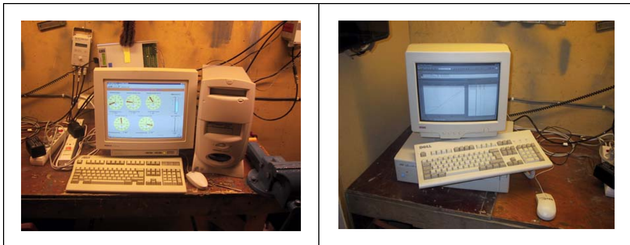
Figur 2. Utstyr for overvåkning av strøm (venstre) og turbiditet (høyre) montert i en brakke på fabrikkkanlegget.
