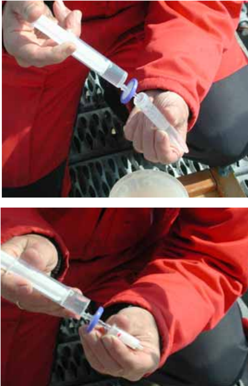
Figur 2. SCF teknikk. Øverst: Filtrering av vannprøve. Nederst: Kombinert filtrering og ionebytting av prøve.
