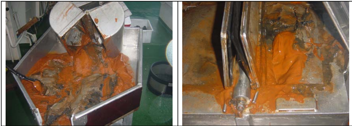
Figur 4. Bunnsediment fra St. 1 ved Vestre kai, Hanneviksbukta. Venstre: åpnet grabb; høyre: topplag sett med åpne inspeksjonsluker.
