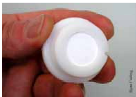
Figur 4. DGT-er består av en plast-beholder fylt med en ionbytttermasse som er åpen mot omgivelsene over en gjennomtrengelig gel.
