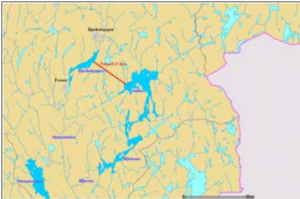
Figur 12. Skisse som viser Setten tatt over til Bjørkelangen via en 5 km fjelltunnel for å fortynne, samt øke gjennomstrømningen i Bjørkelangen.
