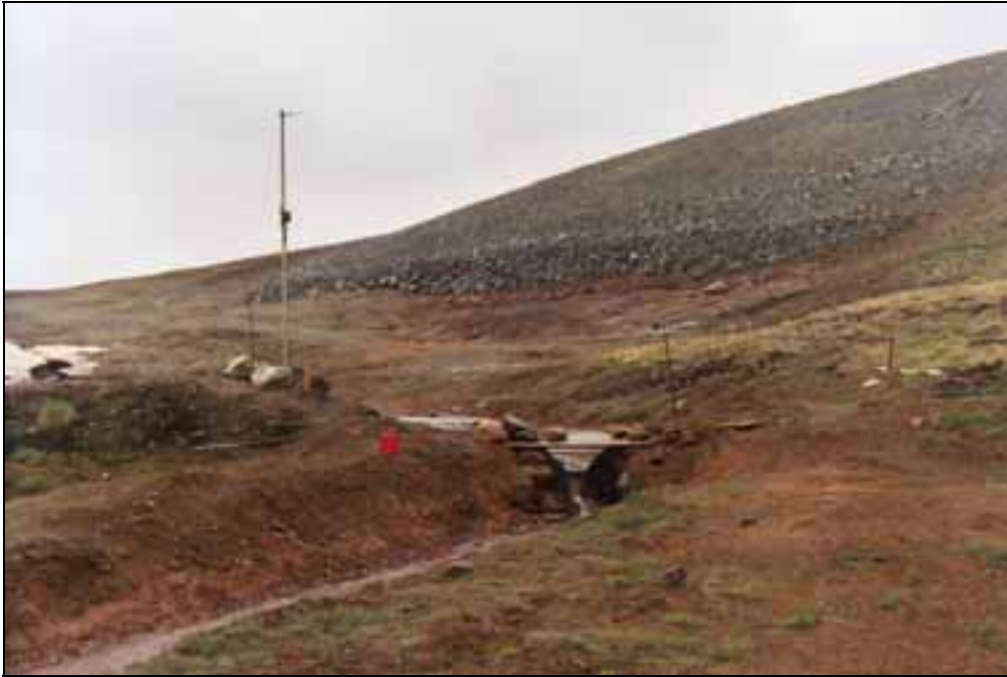
Figur 3. Måledam for samlet avrenning fra tippet høsten 2003 (Foto: E.R. Iversen).
