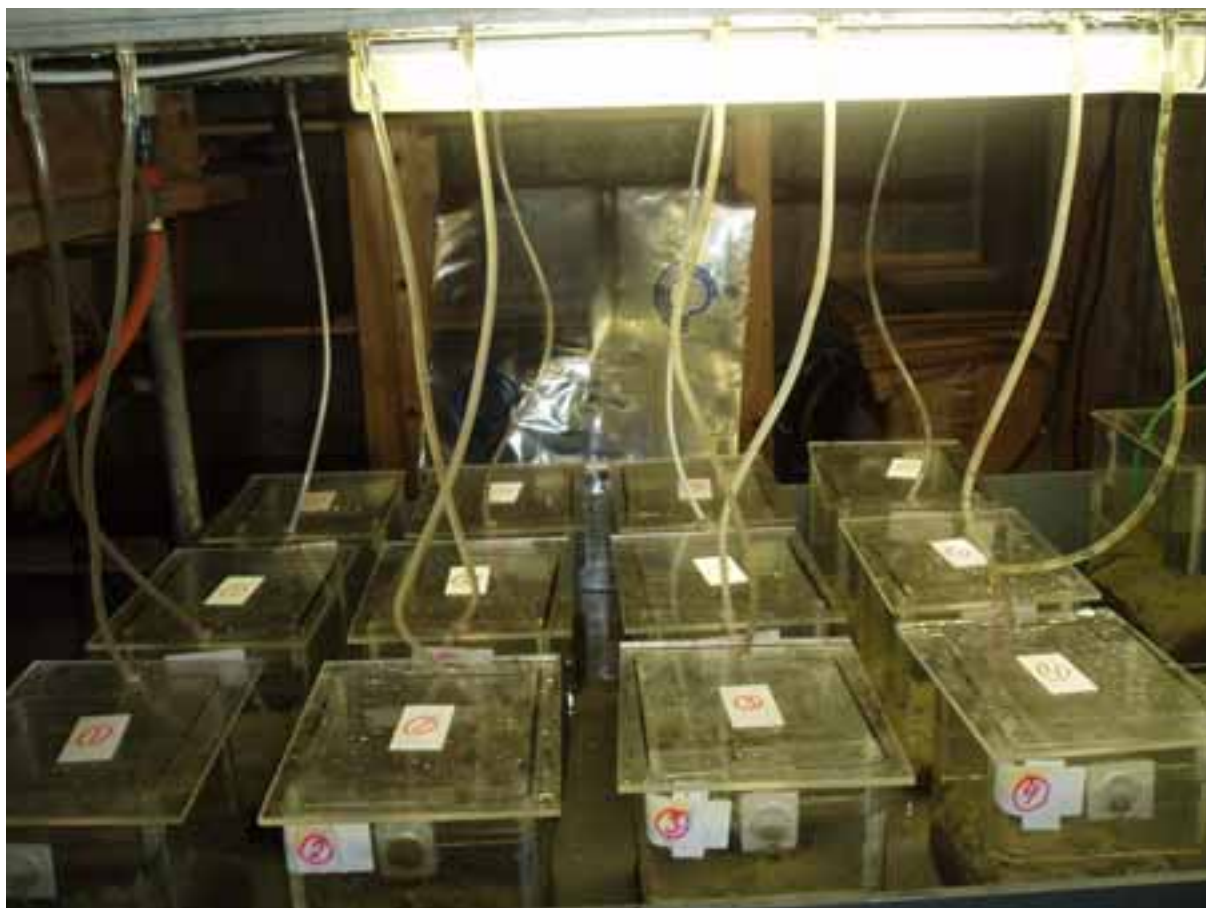
Figur 2. Foto av forsøksoppsett som ble benyttet for testing av biotilgjengelighet og bioakkumulering av tinnorganiske forbindelser.
