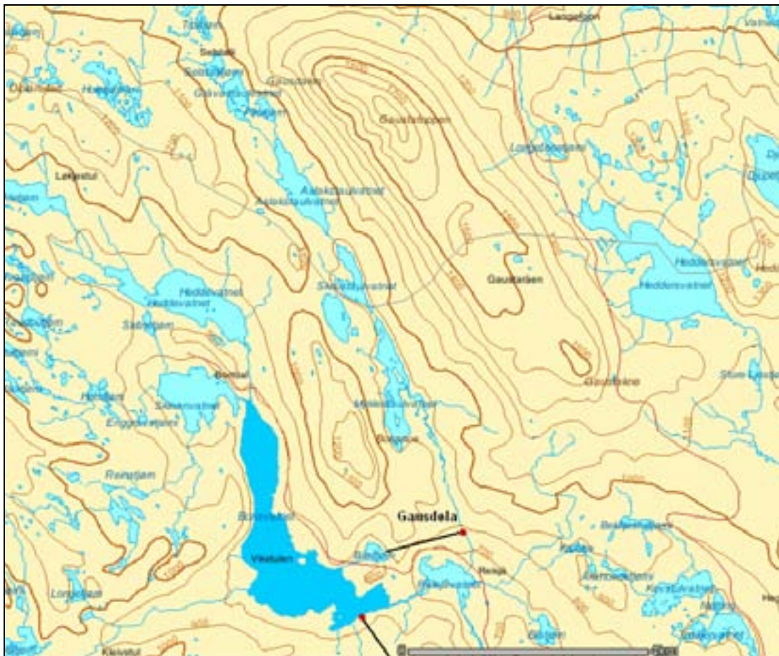
Figur 3. Kartskisse med høydekoter fra NVE Atlas som viser dagens overføring av Gausdøla til Bærtjønn
