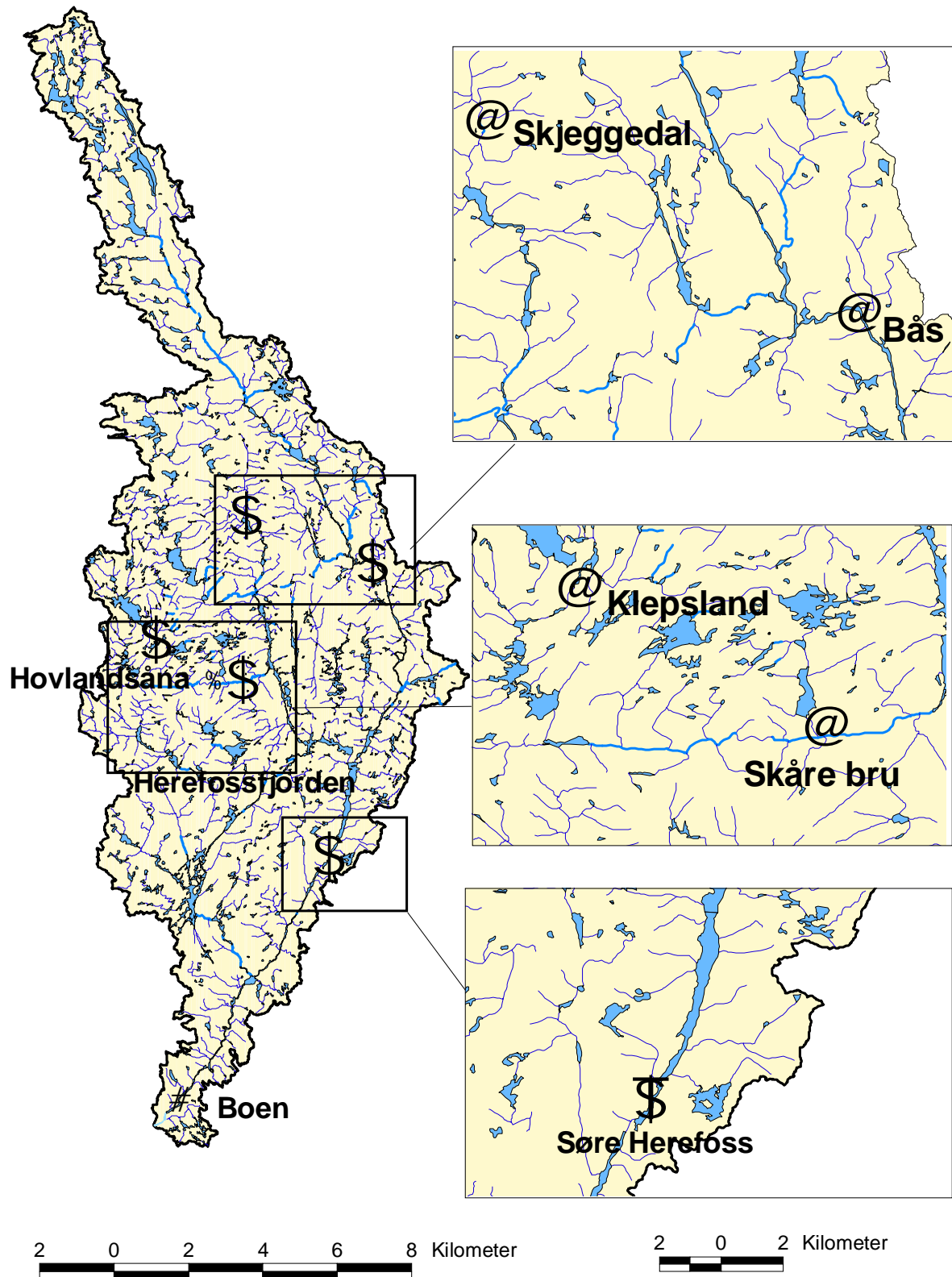
Figur 1. Kart over nedbørfeltet til Tovdalselva med utsnitt av tre områder i stor målestokk som viser plasseringen av kalkdoseringsanlegg (triangler) og pH-målestasjoner (sirkler).
