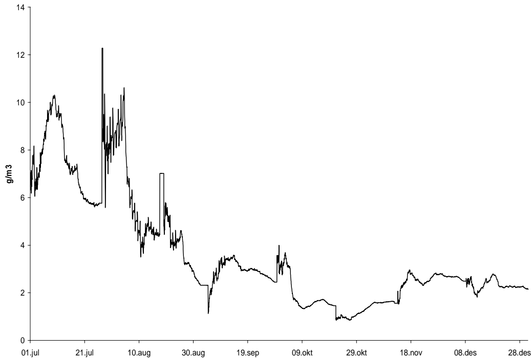
Figur 9. Kalkdosene fra Skåre doseringsanlegg i siste halvdel av 2004. Figuren viser at det først var en overdosering fra anlegget. Senere ble dosene redusert og stilte seg inn noe i underkant av det ønskete dosekravet på 2,6 g/m 3 .
