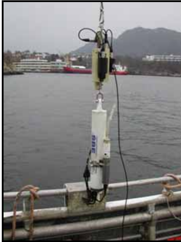
Figur 8. SAIV sonden (øverst) sammen med Seabird SBE19 sonde (for interkalibrering).
