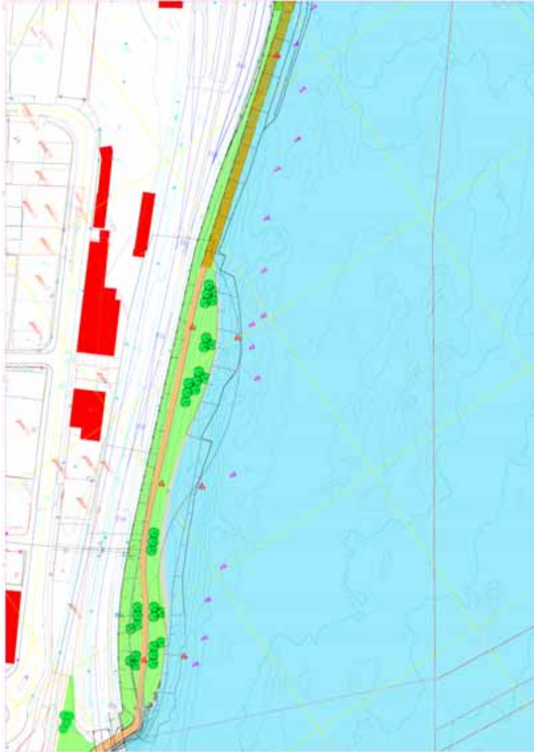
Figur 6. Strømsø siden. Fyllingsområdet forbi jernbanestasjonen ned til jernbanebrua. Røde tall og sirkler angir sted for sedimentprøver, lilla tall og sirkler angir grensen for utbredelse av løst sediment. Kartfigur produsert av Rambøll Norge AS.
