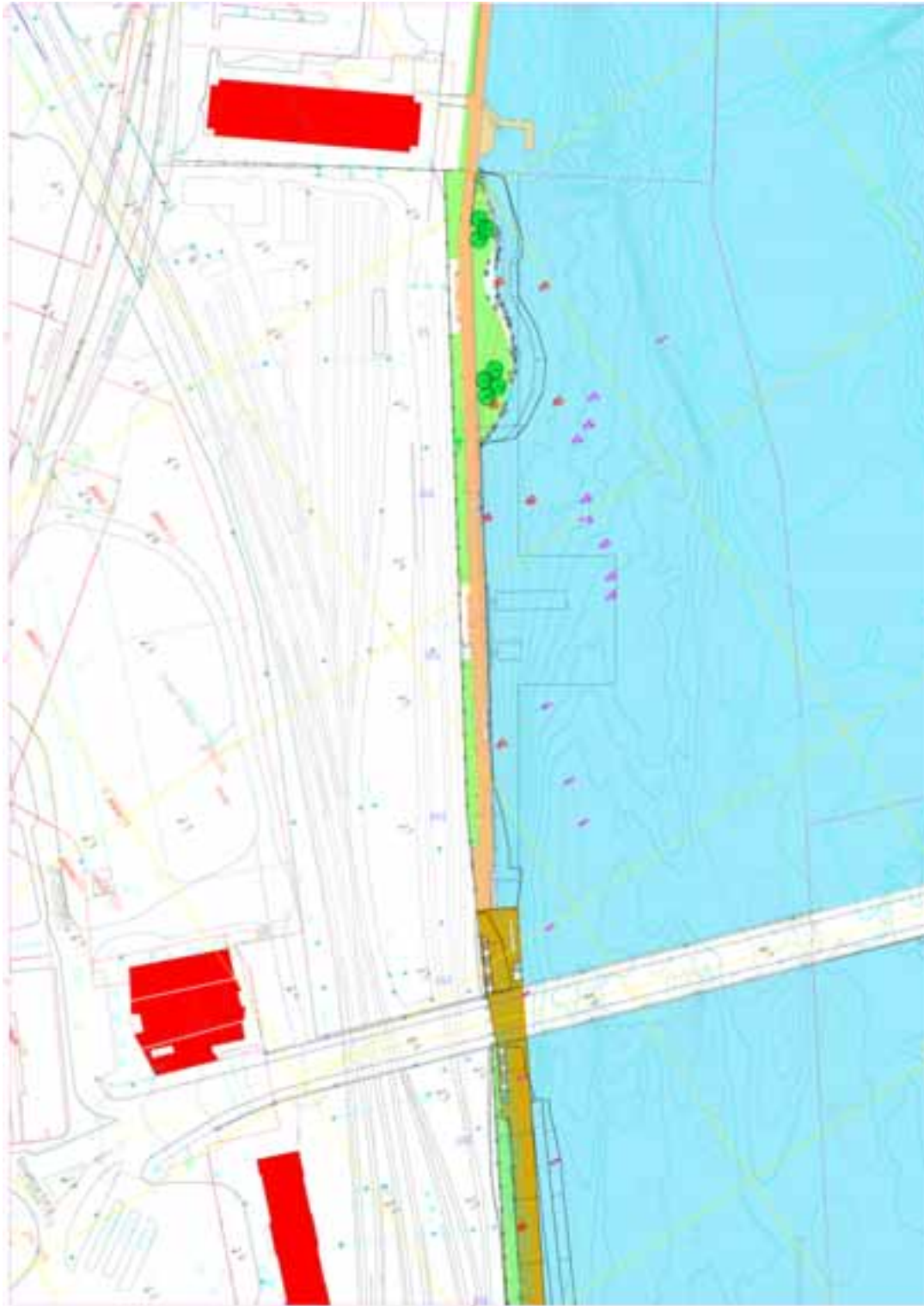
Figur 4. Strømsøsiden. Fyllingsområdet fra Statens hus nedstrøms forbi Bybrua. Røde tall og sirkler angir sted for sedimentprøver, lilla tall og sirkler angir grensen for utbredelse av løst sediment. Kartfigur produsert av Rambøll Norge AS.
