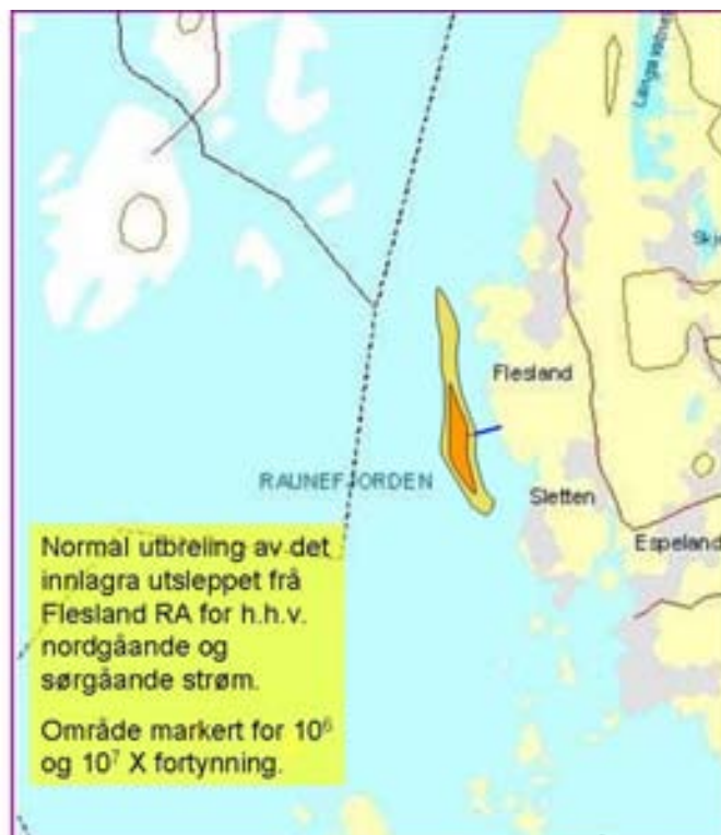
Figur 62. Horisontalfordeling av normal utbreiing av det fortynna og innlagra utsleppsvatnet frå Flesland RA, for nordgåande og sørgåande strøm. Blå strek indikerer avlaupsrøyret. Skya vil typisk representere vatn frå 10 til 17-18 m djup.
