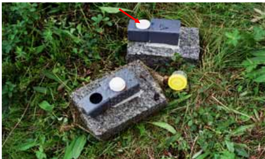
Figur 4. Foto av DGT prøvetageren montert i en beskyttelses ramme og festet på en stein før den ble plassert ut i vassdraget. Foto K. J. Aanes.
