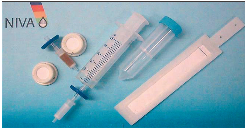
Figur 4. Et utvalg av innholdet i «verktøykassa med DGT- og SCF-prøvetakere»: Fra venstre to DGTer (runde hvite enheter med prøvetakingsvinduet vendt oppover). To SCFer (filter pluss ionebytter og påmontert prøvetakingsprøyte). Til høyre en DGT-sediment-probe som benyttes for å ta profiler av metaller i porevann i sedimenter.
