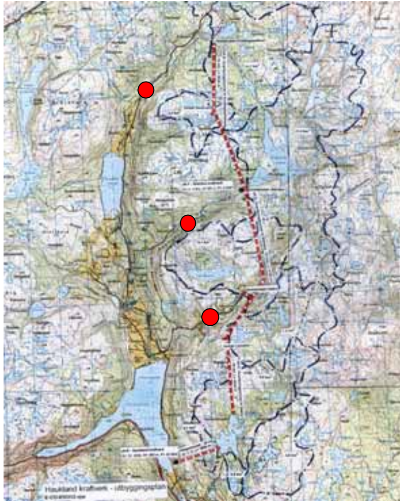
Figur 11: Oversiktskisse av prosjektene i Moisaani, tre småkraftverk versus et stort. Røde punkter viser plassering av småkraftverk. Prosjektene, 3 små versus ett stort, er gjensidig utelukkende. Kilde: Dalane energi
