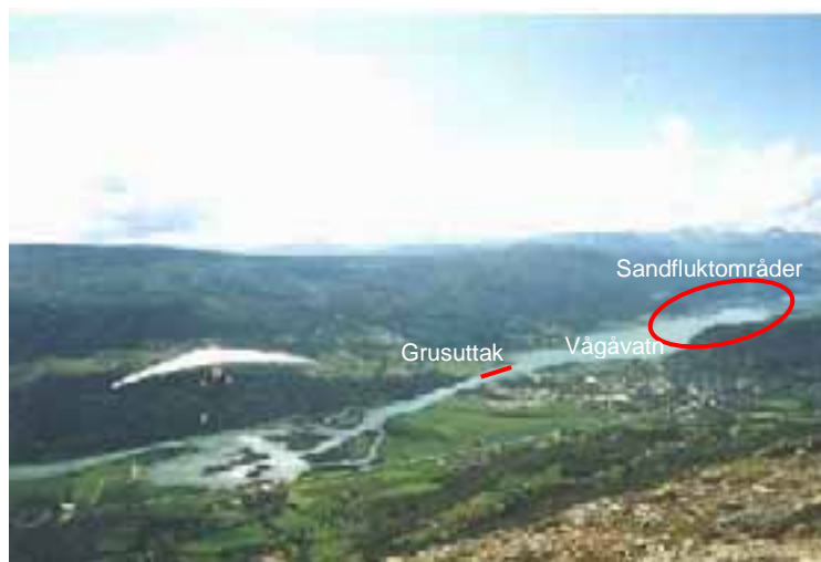
Figur 6: Bilde av Vågavatn med sandfluktområder, grusuttak. Prosjektet innebærer å bygge en terskel/felksibel dam ved utløpet for å holde vannstanden på "normalt" nivå og tilstrekkelig høyt til at sandflukt unngås. Det må etableres et kraftanlegg. Plassering ikke kjent. Kilde: GLB.
