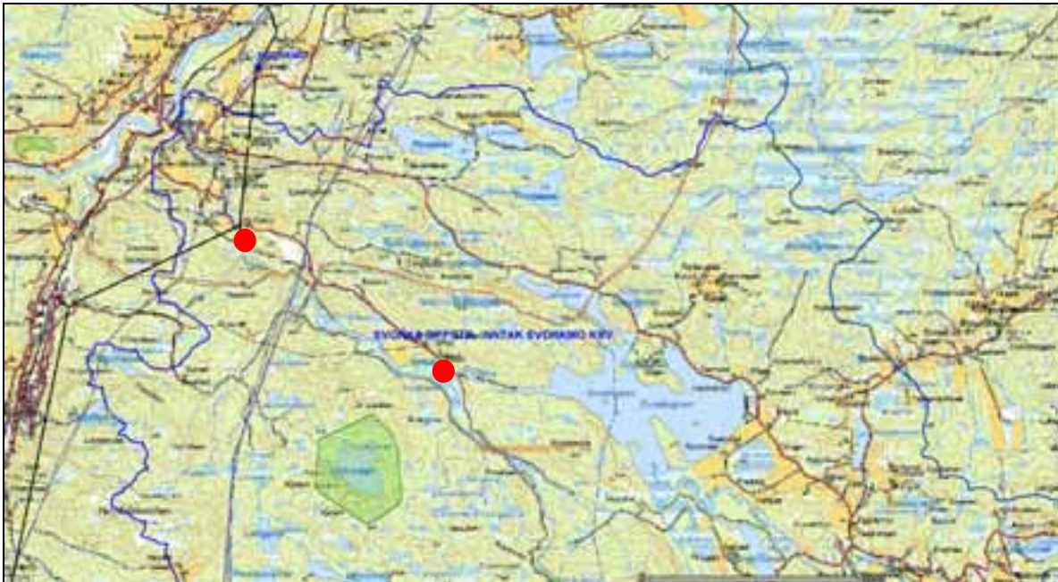
Figur 13: Svorka er vernet oppstrøms inntak til Svorkmo kraftanlegg (supplering av verneplan for vassdrag vedtatt 18. februar 2005). Det foreligger planer for småkraftverk i nedre deler av dette sidevassdraget til Orkla. Røde punkter indikerer mulig plassering av småkraftverk. Disse planene er ikke viderutviklet
