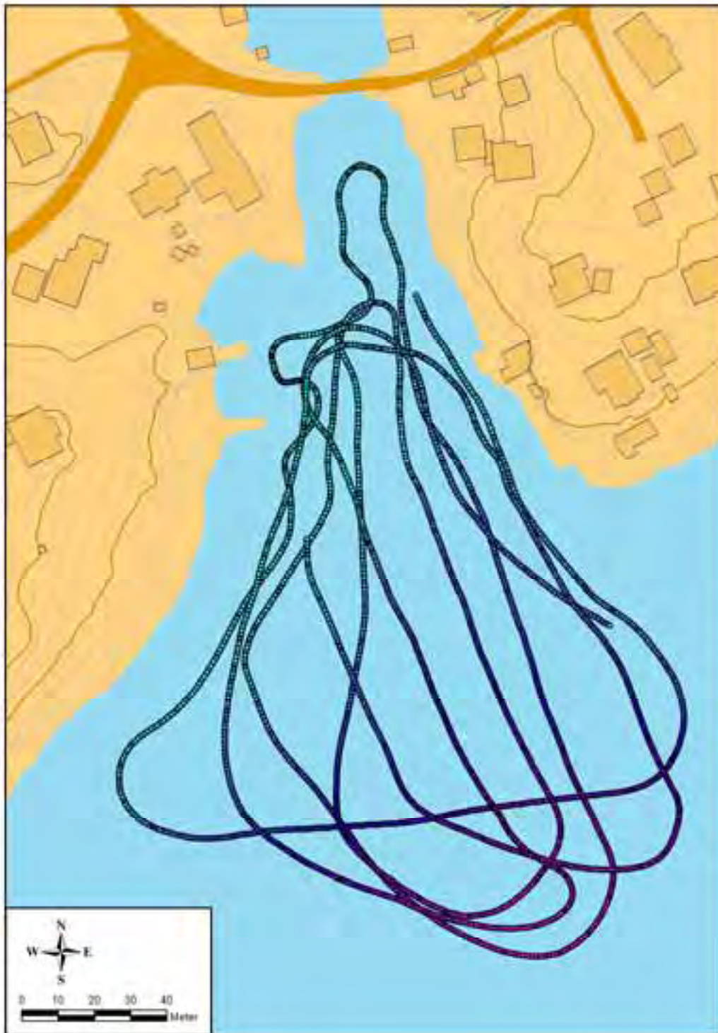
Figur 7. Tracing – strekninger som ble kjørt for kartlegging med ekkolodd.
