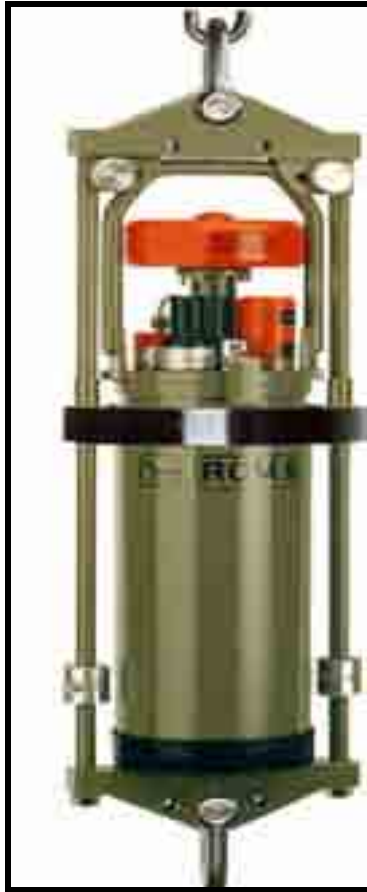
Figur 5. Aanderaa RCM9 doppler strømmålar, også med turbiditet, salt- og temperatur sensor.
