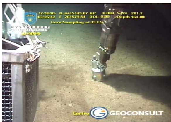
Figur 2. Prøvetaking av sedimenter med ROV.
