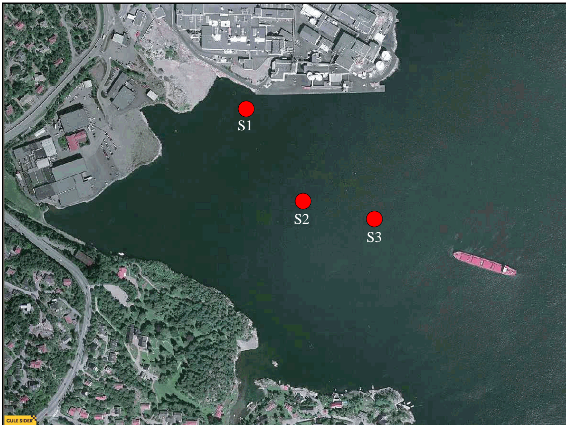
Figur 7. Plassering av instrumenter for måling av strømhastighet, strømretning og turbiditet (kartgrunnlag: Telefonkatalogen).
