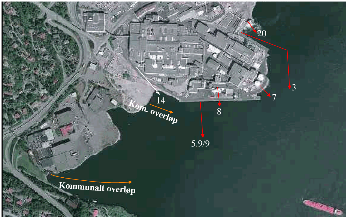
Figur 6. Plassering av utslipp fra Falconbridge Nikkelverk og av kommunalt overvann. For nærmere beskrivelse se teksten i kap. 2.2-2.3 og Vedlegg A.
