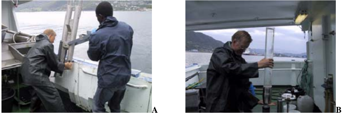
Figur 3. Innsamling av sedimenter. A: Dobbelt Gemini kjerneprøvetaker. B: Kjerneprøven.
