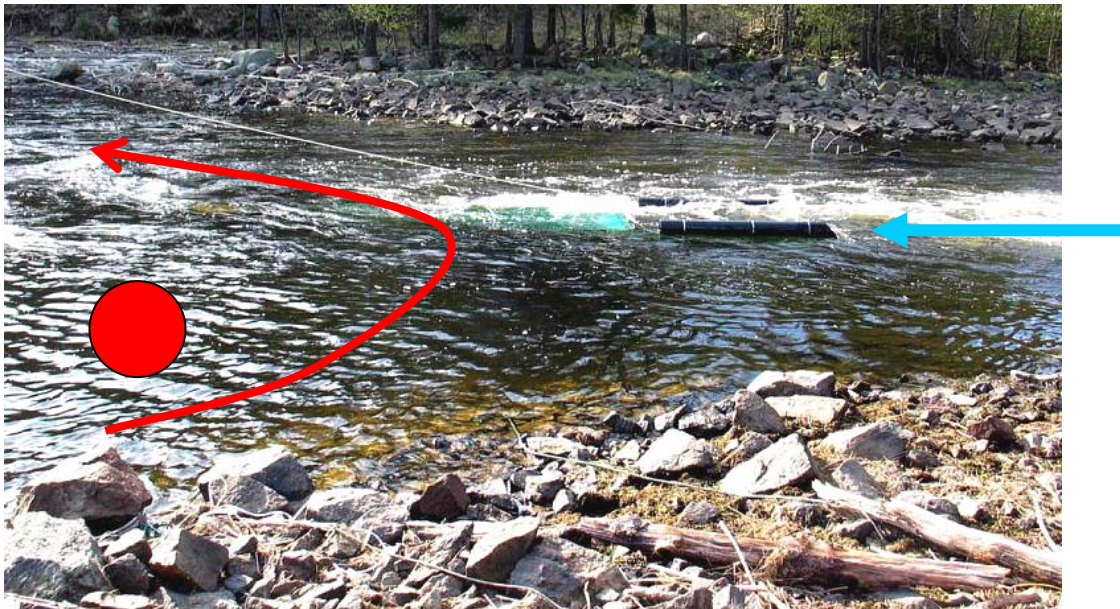
Bilde: Plassering av River-fishlift i Storelva. Retningen på elvevannet er markert med blå pil. Retningen på kompensasjon strømmen i Songevannet er markert med rød pil. Prøvetakingssted for vannprøver er markert med sirkel.
