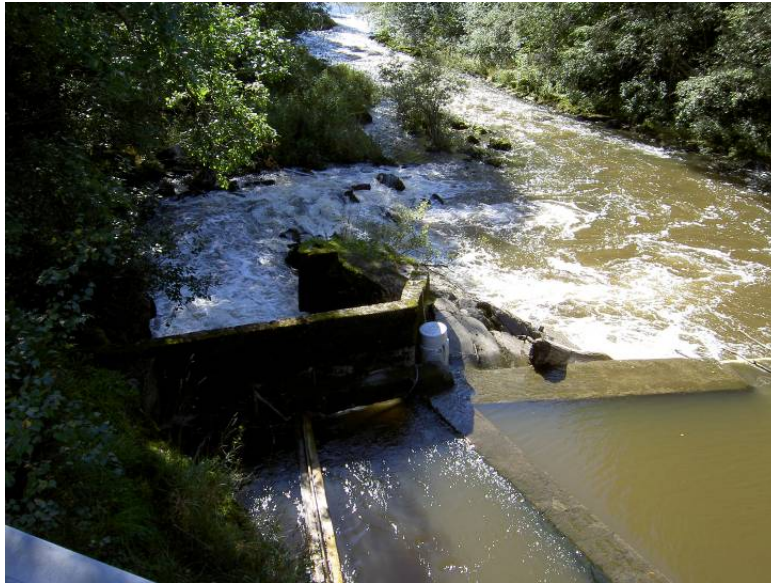
Figur 7 Hobølelva ved Kurefossen. Automatisk prøvetaker (ISCO) midt i bildet. Prøvetakeren ble senere flyttet opp til venstre i bildet da den var flomutsatt. Inntaksslengen forble imidlertid på samme sted i elva.
