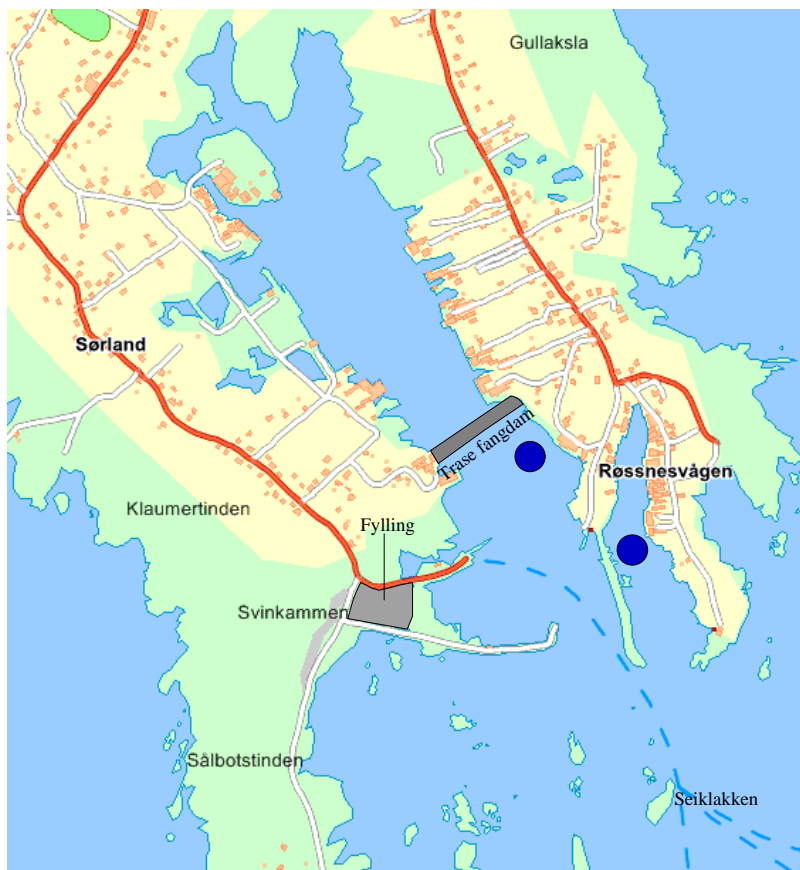
Figur 2. Posisjoner for overvåking av turbiditet (blå sirkel) under mudring i traseen for fangdam og i Røssnesvågen.
