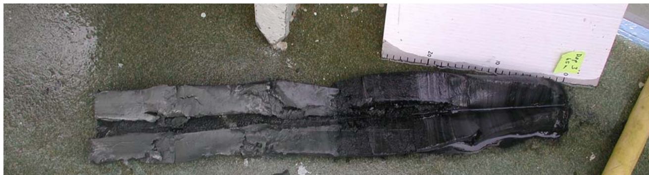
Fig. 8139. Kjerne Dep 3A etter at de øverste 2 cm var snittet av.
