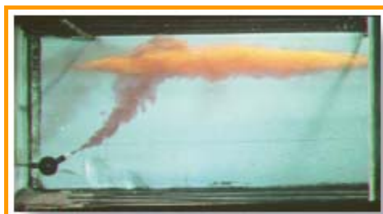
Figur 16. Foto frå laboratorieforsøk med farga oppstigande (lett, ferskt) vatn i ei sjikta væske (sjøvatn).
